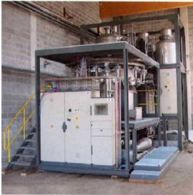
C'est dans un gazogène comme celui-ci, qui est fabriqué par la société belge Xylowatt, qu'Electrabel valorisera les 15 tonnes de déchets de bois produits chaque jour par la PME Radermecker, à Battice.
